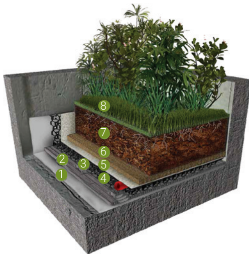
3 Lắp đặt tấm thoát nước: GrasCell DC30 hoặc PlanterCell 50
